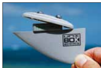
Bei der UNIBOX werden die Finnen komplett durch den Rumpf gesteckt und in der Finnenbox, also über dem eigentlichen Profil, mithilfe einer kleinen Plastikplatte verschraubt
