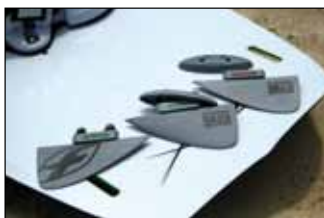
An den Seiten haben die Finnen farbige Markierungen, damit das asymmetrische Profil auch in Fahrtrichtung richtig montiert wird. Dabei steht grün für Steuerbord (rechts) und rot für Backbord (links)
